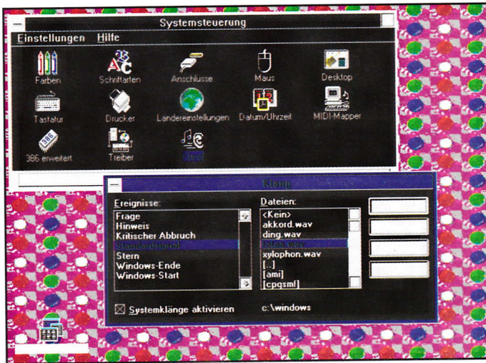
Bild 7 Neu unter Windows ist die Unterstützung von Soundkarten. In der Systemsteuerung lassen sich einzelnen Ereignissen Klänge zuordnen
