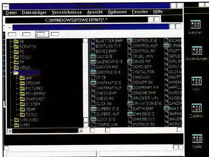
Bild 3 Der Dateimanager im Look des Norton Commanders. In je einem Panel können Baumdiagramm bzw. Dateinamen dargestellt werden. Jedes Fenster erhält ferner seine eigenen Laufwerks-Ikonen
