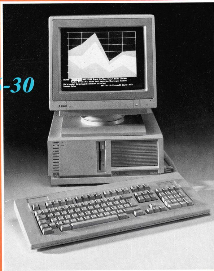
reicht (NEAT – New Enhanced Advanced Technology). Standardmäßig ist der ABC mit einer 30-MByte-Festplatte und einem 3 1/2-Zoll-Floppylaufwerk mit 1,44 MByte (senkrecht in die Mitte der Frontblende eingelassen)
