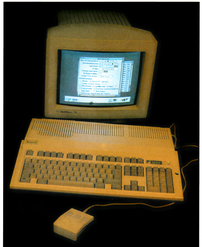
Bild 1 Äußerlich im Homecomputer-Look, innerlich mit workstationnahen Leistungen: der RISC-Rechner Archimedes A3000
