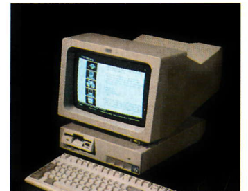
Das Monitoregehäuse besitzt leider keinen Drehfuß, sondern kann nur mittels einer einfachen Klappstütze geneigt werden
