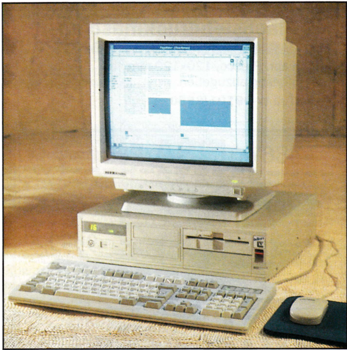
Das flache Rechnergehäuse erlaubt für den darauf stehenden 17-Zoll-Monitor noch eine akzeptable Betrachtungshöhe
